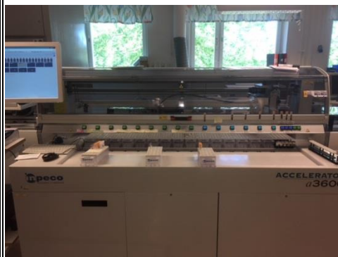
In- och utmatningsstationen
